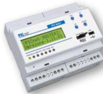
Le centrali della serie DABnet sono dotate di Web Server integrato che permette il controllo remoto delle zone direttamente da browser web di PC e smartphone.
