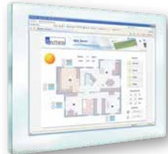
La suite software PN LINK PRO fornisce all'utente la possibilità di un controllo completo del sistema audio DABnet. Piantine grafiche interattive permettono di selezionare l'area da interesse e controllarne tutti i parametri come il livello dell'audio, la sorgente riprodotta, programmazioni orarie o appartenenza a gruppi di riproduzione.
